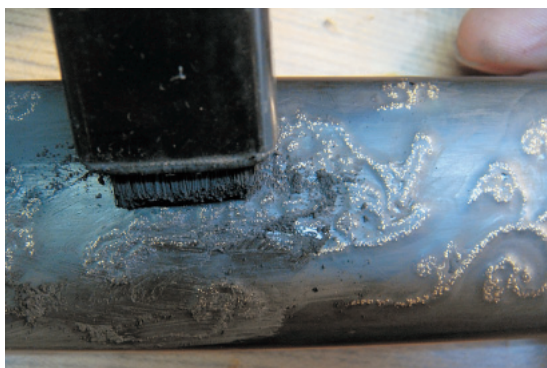
挿図35 炭粉による2回目の研ぎ (工程⑨)
