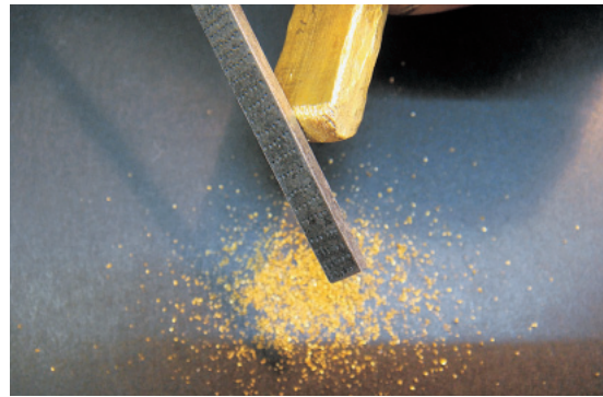
挿図17 金の塊を削って鑿粉を作る
