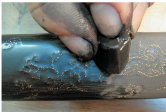
挿図37 木炭による研ぎ出し（工程⑭）
