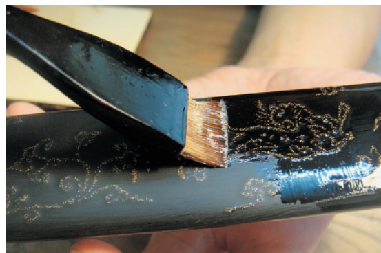
挿図36 透漆による4回目の塗り込み (工程⑬)
