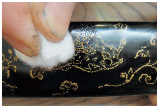
挿図38 生漆を綿で擦り込む（工程⑰）
