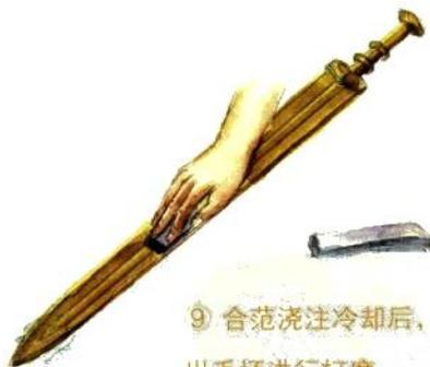
9 合范浇注冷却后，拿出毛坯进行打磨
